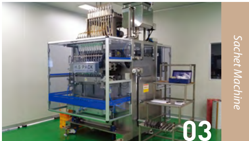
액상 스틱형 파우치 기기 - 80,000포 Sachet Machine - 80,000 sachets / 10 ~ 15ml
