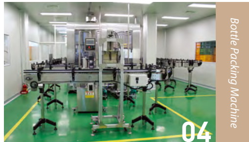
병 포장 기기 - 10,000병(250ml 기준) Bottle Packing Machine - 10,000 bottles / 100 ~ 1,000ml
