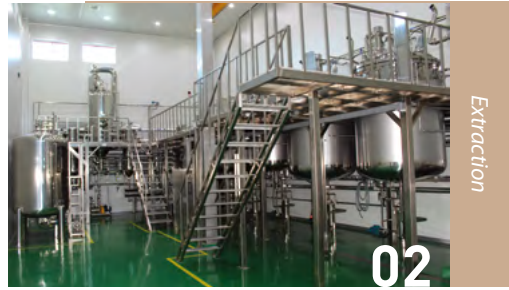
추출농축기 - 11.5톤 Extraction - 11.5 ton / 5 Tank
